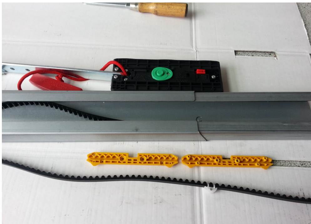
Overzicht van trolley, gele houder & eindschakelaar actuator
